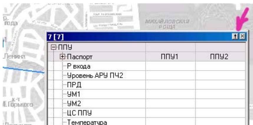
Рис 6.2. Открытие окна установки пороговых значений параметров станции.
