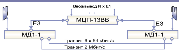
Скорость 34 Мбит/с, ввод-вывод дополнительного канала 2 Мбит/с и транзит всех дополнительных каналов 64 кбит/с
